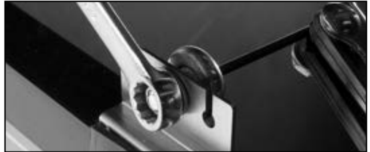
Fig. 1. Adjust the roller.
