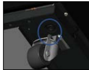
Fig. 6. Loosen castor bolt.
